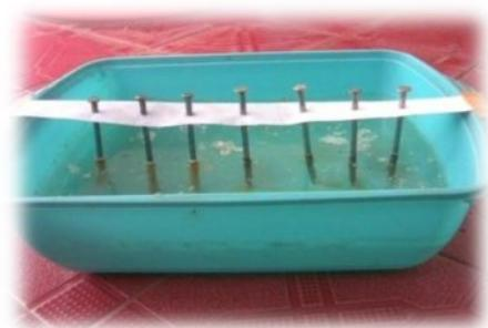
Gambar 1. Tampilan kotak uji korosi.
